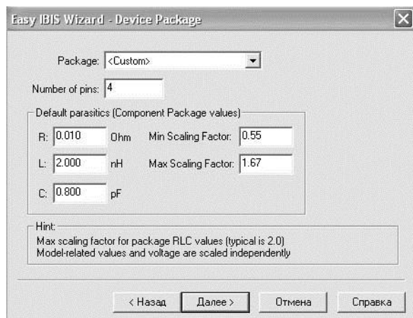
Рис. 1. Выбор паразитных параметров для корпуса
